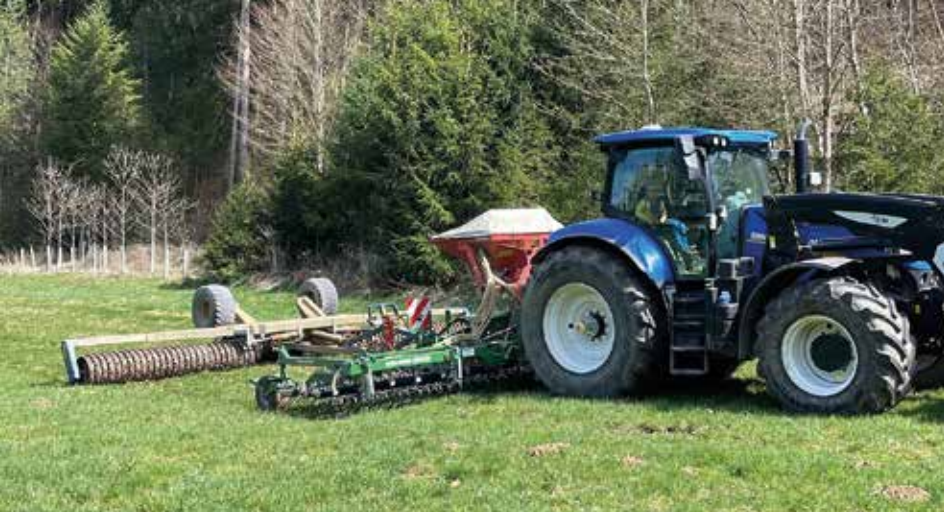
links: Bei großflächigen, aber flachen Schäden bietet sich die Reparatur mit einer Wiesenschleppes/-striegel an. rechts: Tiefere Schäden können mit einer Kreiselege auch in Kombination mit einer Sähmaschine bearbeitet werden.
